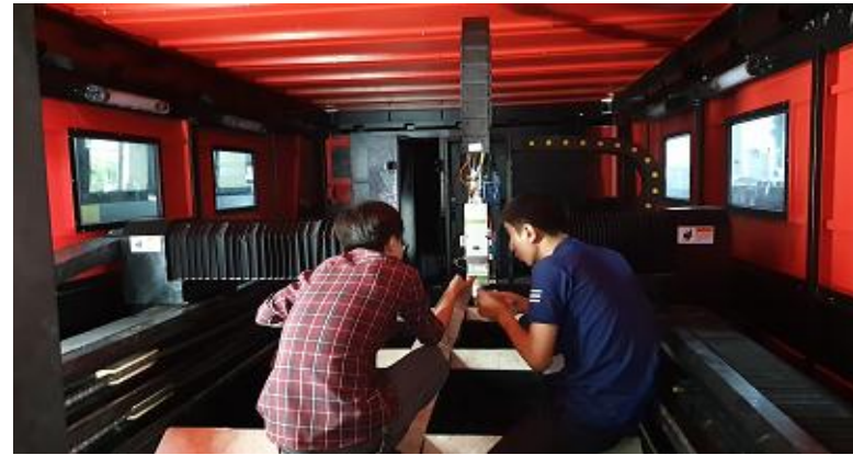
Thay đầu súng 8kw máy Weldcome
